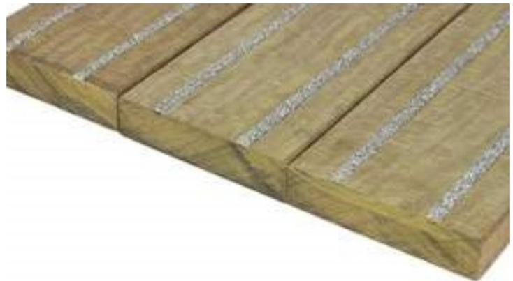
A l'aide d'une meuleuse tenue à la main, coupez l'agrégat uniquement, puis coupez le reste de la planche avec une tronçonneuse ou une scie à main.
