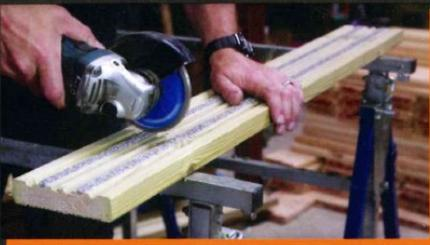
Utilisez une lame disque diamant polycristallin Stehle pour couper l'agrégat et le bois sans meuleuse et sans avoir à changer régulièrement les lames.
